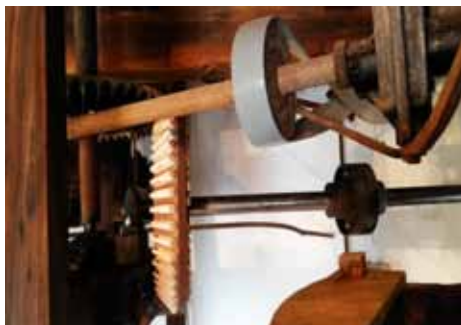
Der Antrieb mit neuer Welle, Antrieb Rührwerk und neue Kämme. Fotos: F. Cloer
