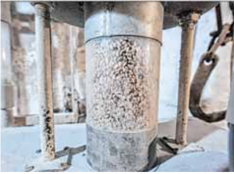
Das Getreide wird über Kunststoffröhren in den Walzenstuhl geführt.
