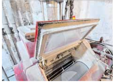
In den Walzenstühlen zerquetschen zwei mächtige Stahlwalzen das Getreidekorn.
