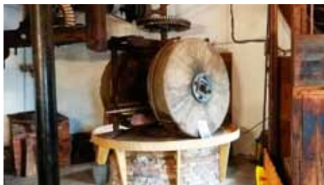
Der Antrieb mit neuer Welle, Antrieb Rührwerk und neue Kämme. Fotos: F. Cloer
